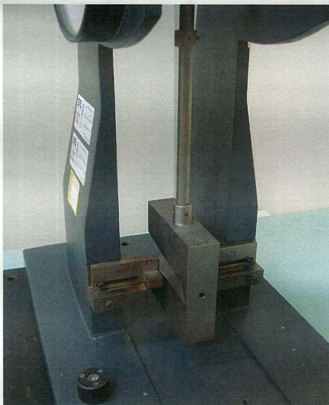
Foto 04 – Base de apoio e martelo para aplicação do impacto.
