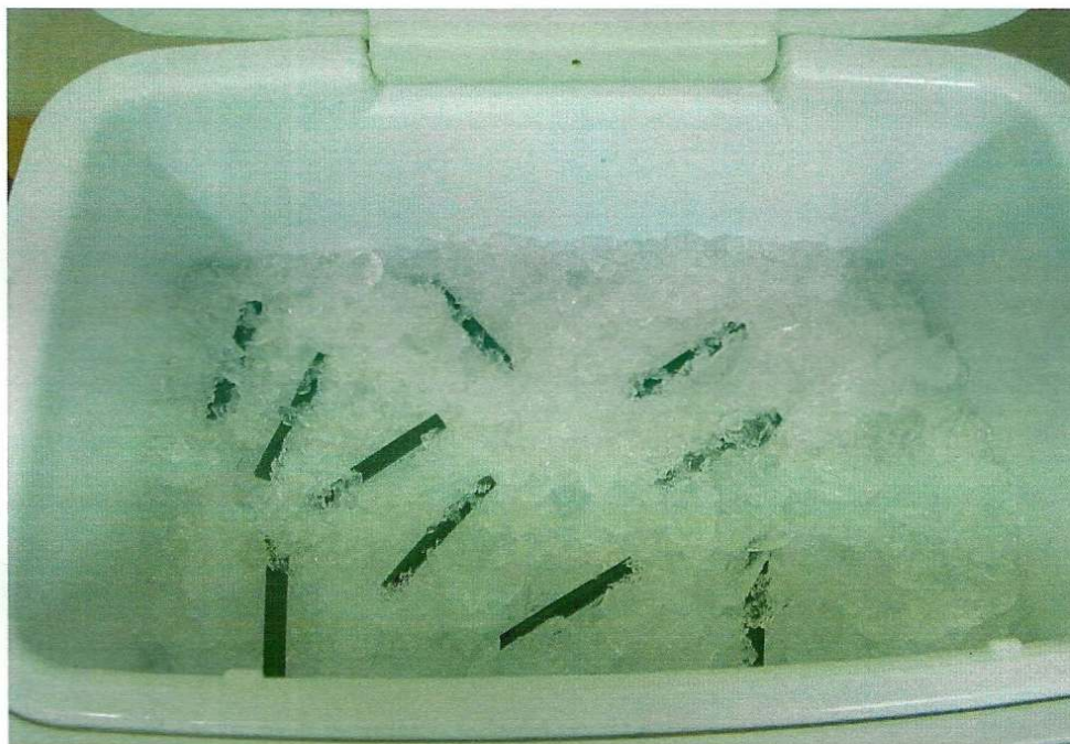
Foto 02 – Corpos de prova condicionados a 0°C em banho líquido (gelo triturado). Temperatura verificada através do termômetro TD 01.
